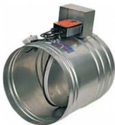
Предел огнестойкости клапанов: Клапан КЛОП-1(60) - в режиме НО (огнезадерживающего) и НЗ - EI 60, в режиме дымового - EI 60 / E 60. Клапан КЛОП-1(90) - в режиме НО (огнезадерживающего) и НЗ - EI 90, в режиме дымового - EI 90 / E 90...
