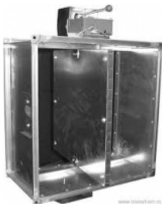
Клапан огнезадерживающий КОЗП, ТУ 4863-023-15185548-04, является элементом общеобменной системы вентиляции и предназначен для автоматической блокировки распространения огня (дыма) через вентиляционные каналы систем вентиляции, кондиционирования и воздушного отопления при пожаре. Клапаны КОЗП имеют предел огнестойкости EI 60...
