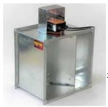
Клапан КПВ-1 предназначен для блокирования распространения огня и продуктов горения по воздуховодам, шахтам и каналам систем вентиляции и кондиционирования при пожаре в зданиях и сооружениях различного назначения...
